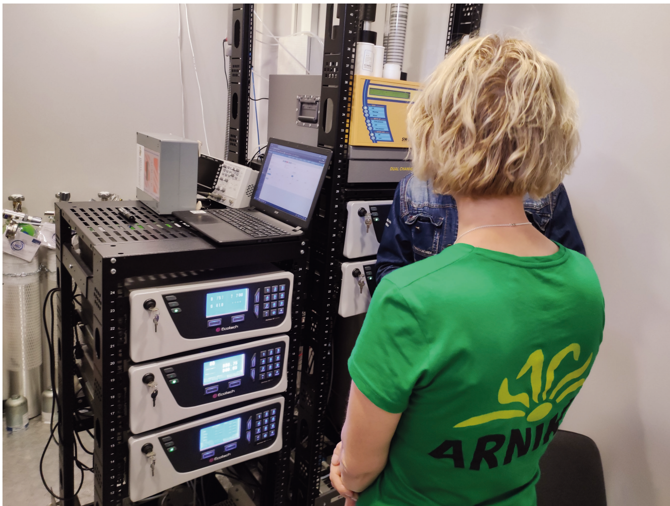
Вимірювальне обладнання референтної стаціонарної станції моніторингу якості повітря. Дніпро, 2021 р.
